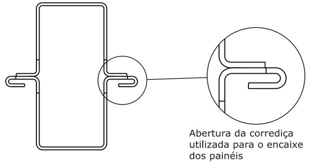
Abertura da corredeira utilizada para o encaixe dos painéis
