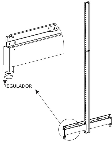
**3** Encaixe as bordas do painel nas corredeiras das colunas e puxe para baixo. Os painéis da gôndola são montados de cima para baixo. Observar atentamente os detalhes das imagens abaixo.
